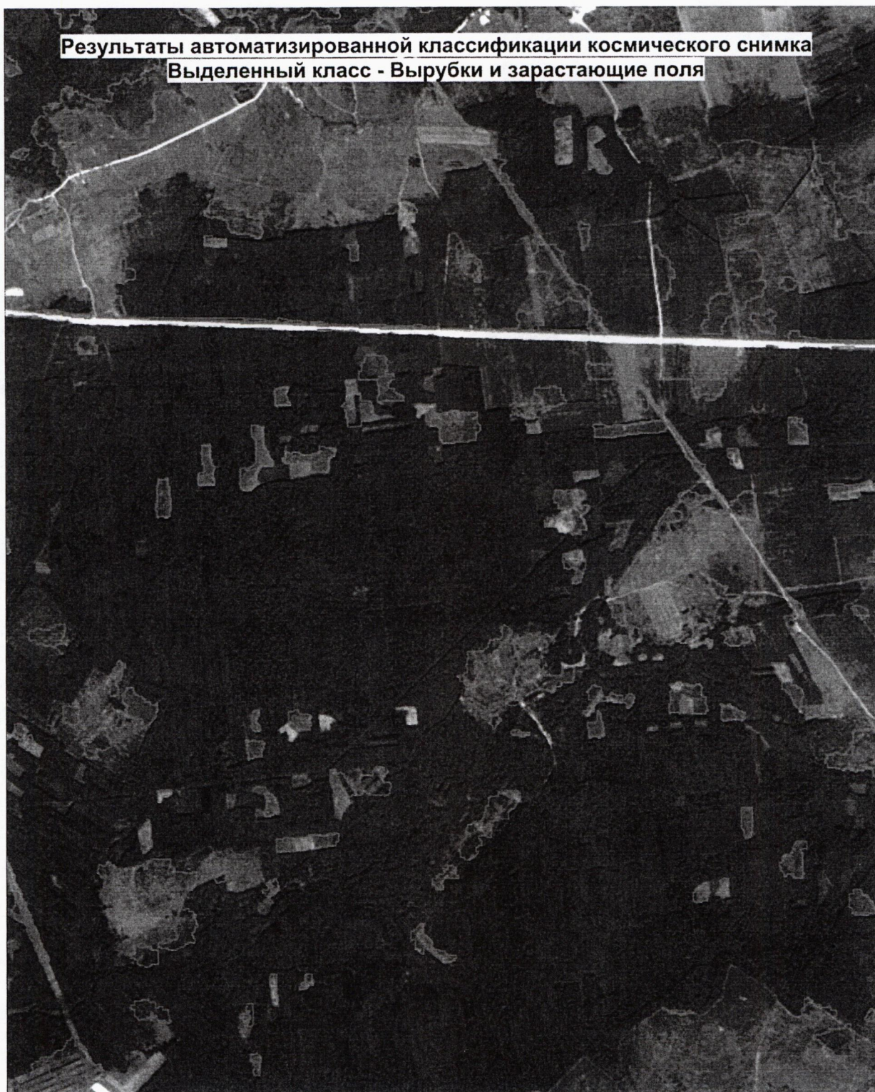
Рисунок 17 – Результаты автоматизированной классификации космического снимка. Выделенный класс – Вырубки и зарастающие поля
