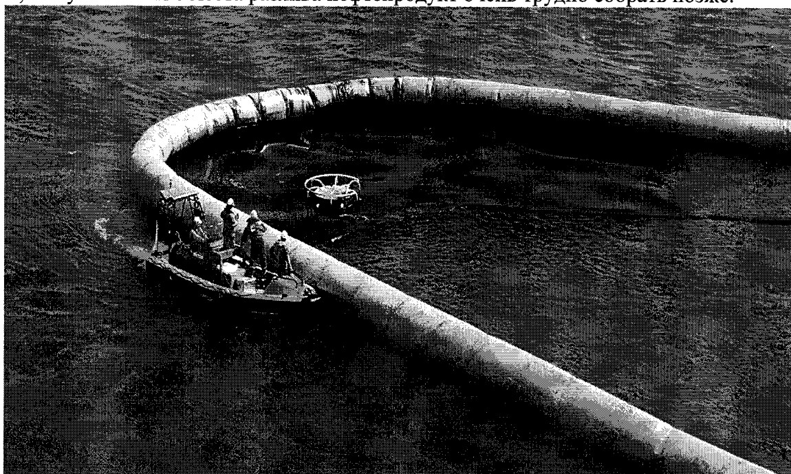
Рис. 3.26. Сбор нефтепродукта скиммером
