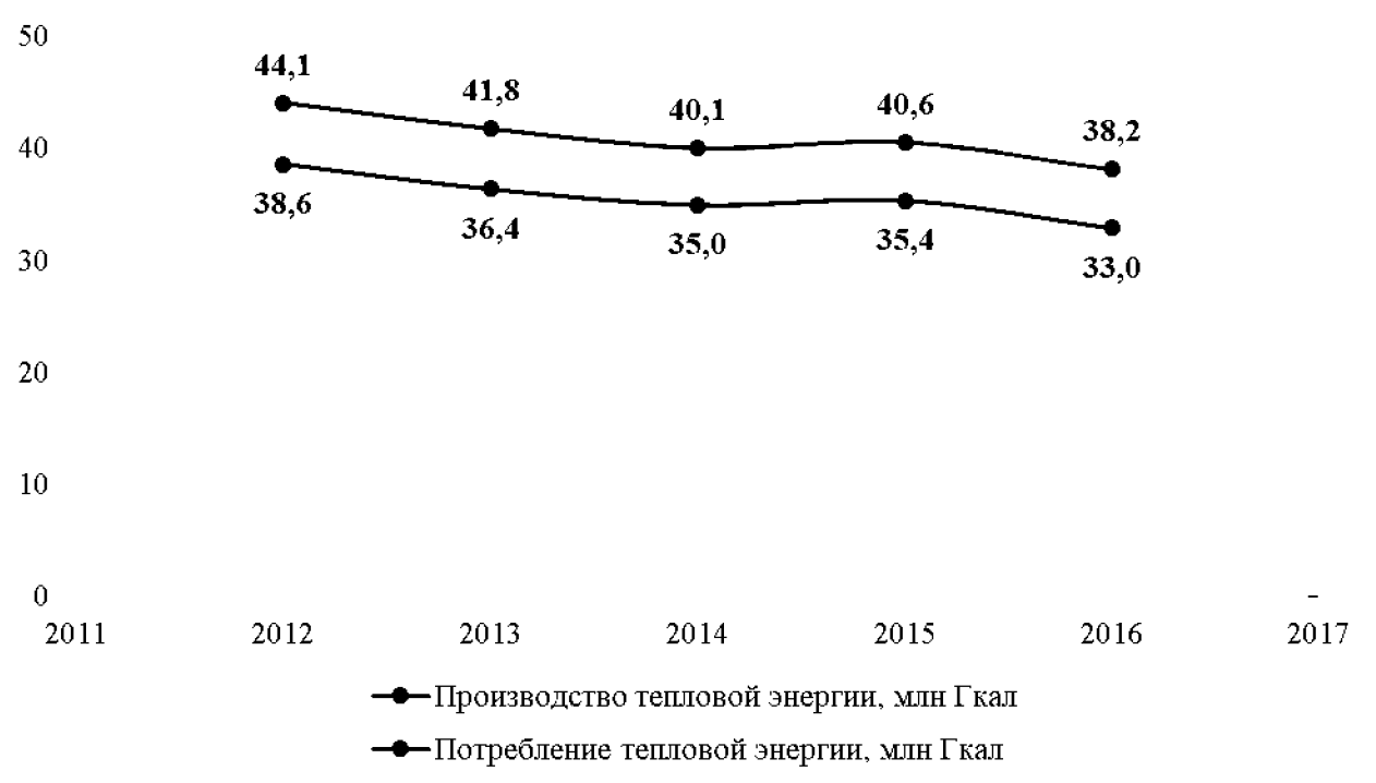
Рисунок 4. Динамика потребления тепловой энергии в системах централизованного теплоснабжения Иркутской области
