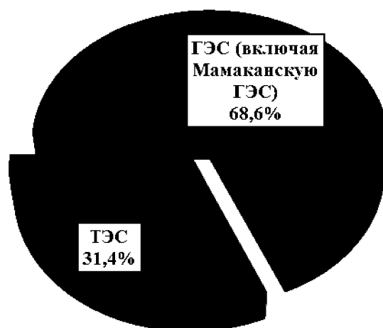
Рисунок 5. Структура установленной электрической мощности
