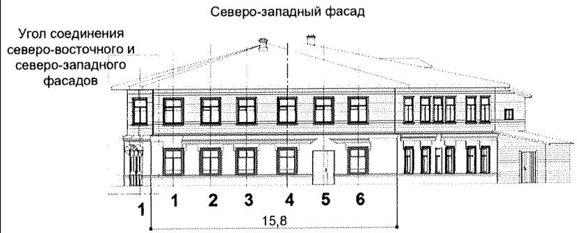
5.3)тянутый профилированный межэтажный карниз основного объема;
