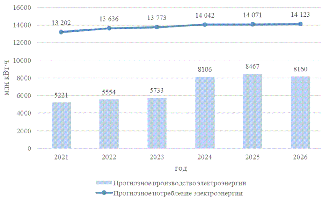
Рисунок 27 – Перспективные балансы электроэнергии энергосистемы Липецкой области на период до 2026 года (региональный вариант развития)
