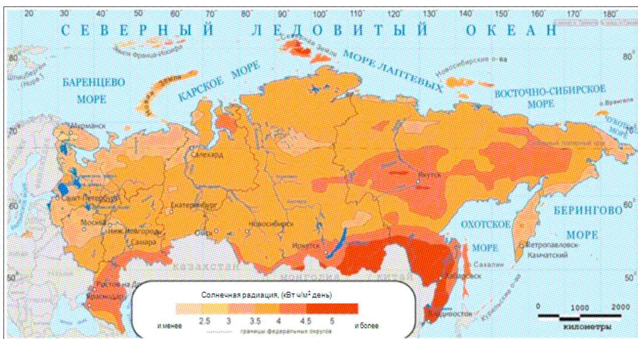
Рисунок 23 – Карта потока солнечной радиации, приходящегося на 1 м 2 за один день на территории РФ
