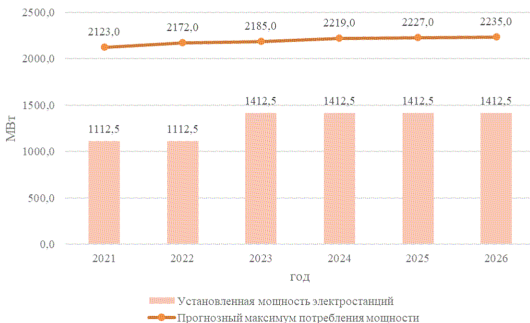
Рисунок 26 – Перспективные балансы мощности энергосистемы Липецкой области на период до 2026 года (базовый вариант развития)
