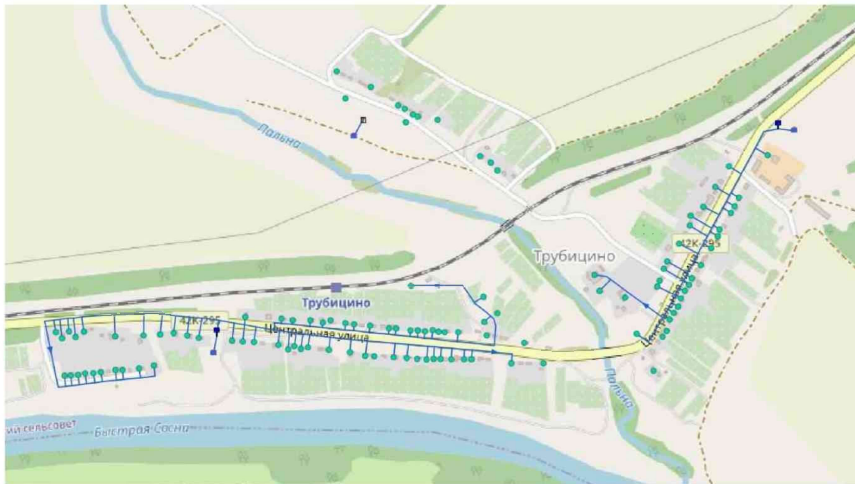
Рисунок 10. Объекты централизованной системы водоснабжения д. Трубицино
