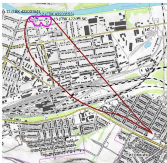
↑ С План второго и третьего поясов ЗСО водозабора «Технической воды» станции Елец ОАО «РЖД», г.г. Елец, Липецкая область М 1:20 000
