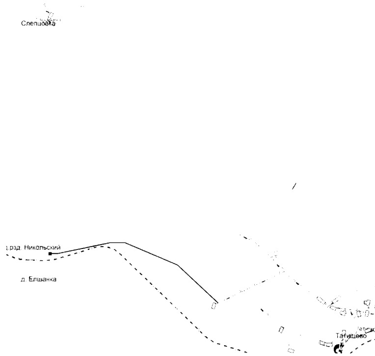
Схема 187. Распределительный газопровод в ж/д разъезд Никольский
