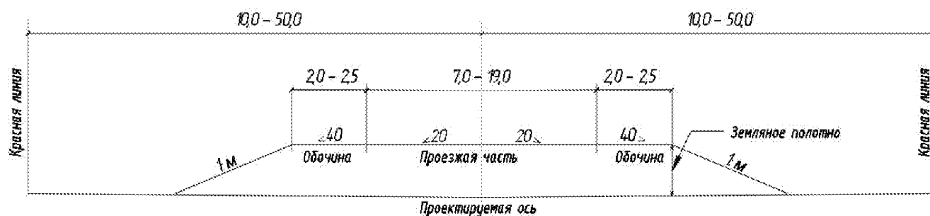
Рис. 1 Поперечный профиль автодороги
