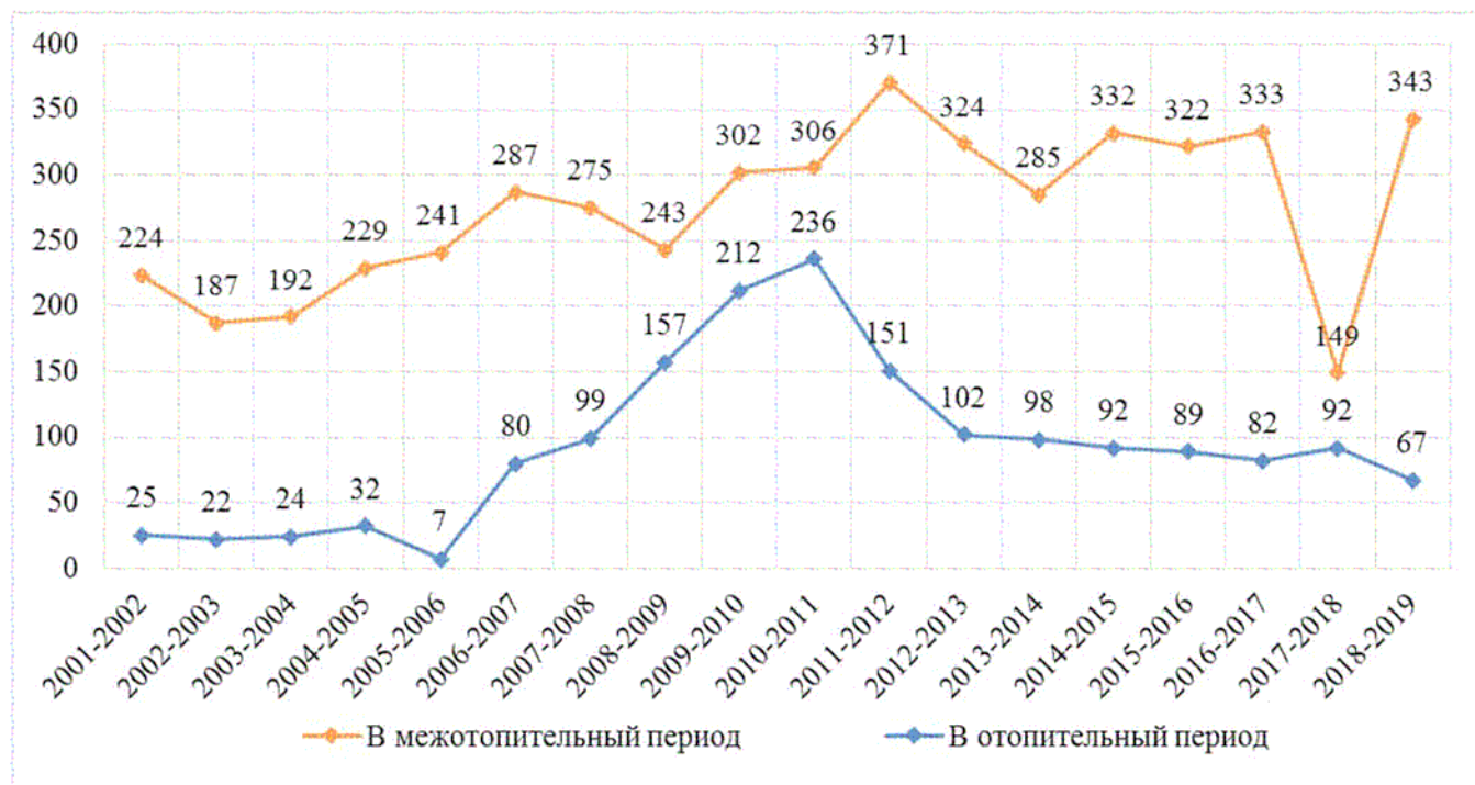
Рисунок 21. Количество повреждений тепловых сетей АО «ЕТК»
