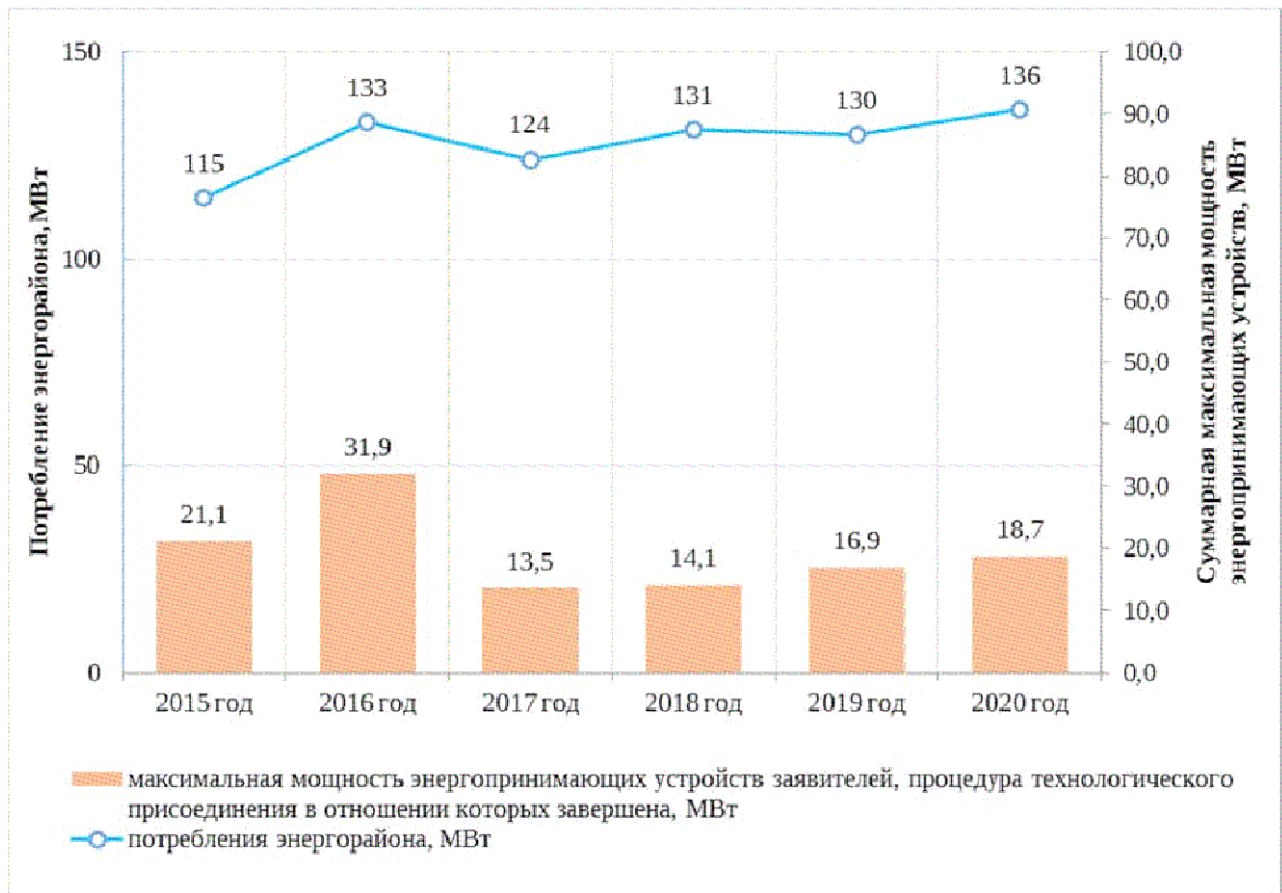
Рисунок 17. Динамика прироста фактической нагрузки в энергорайоне транзита 110 кВ Южная – Нижне-Исетская – Сибирская
