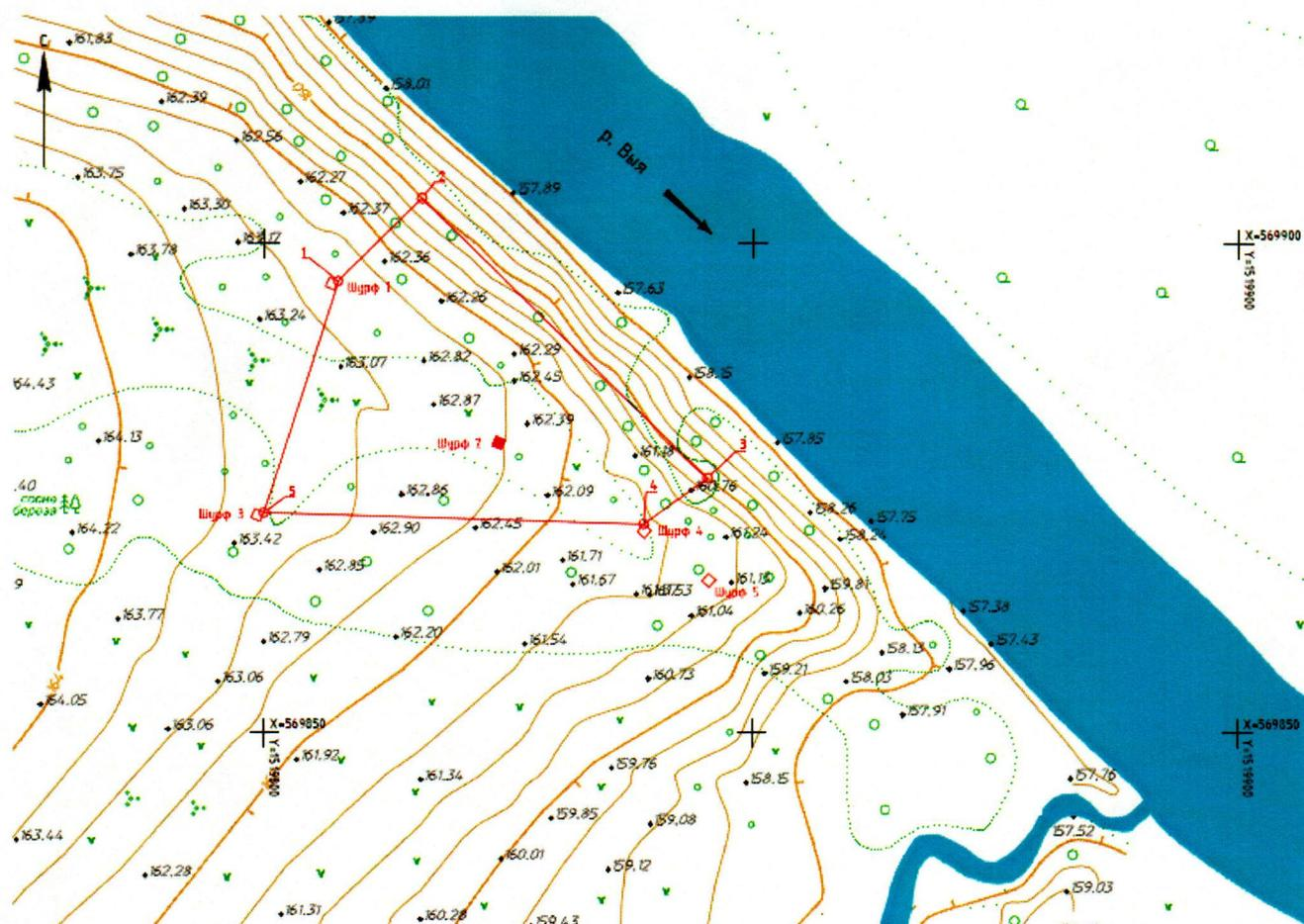
2. Координаты поворотных точек во Всемирной геодезической системе координат (далее – WGS-84) и местной системе координат Свердловской области (далее – МСК-66) определены геодезическим методом и приведены в таблице, погрешность определения координат составляет 0,1 метра.
