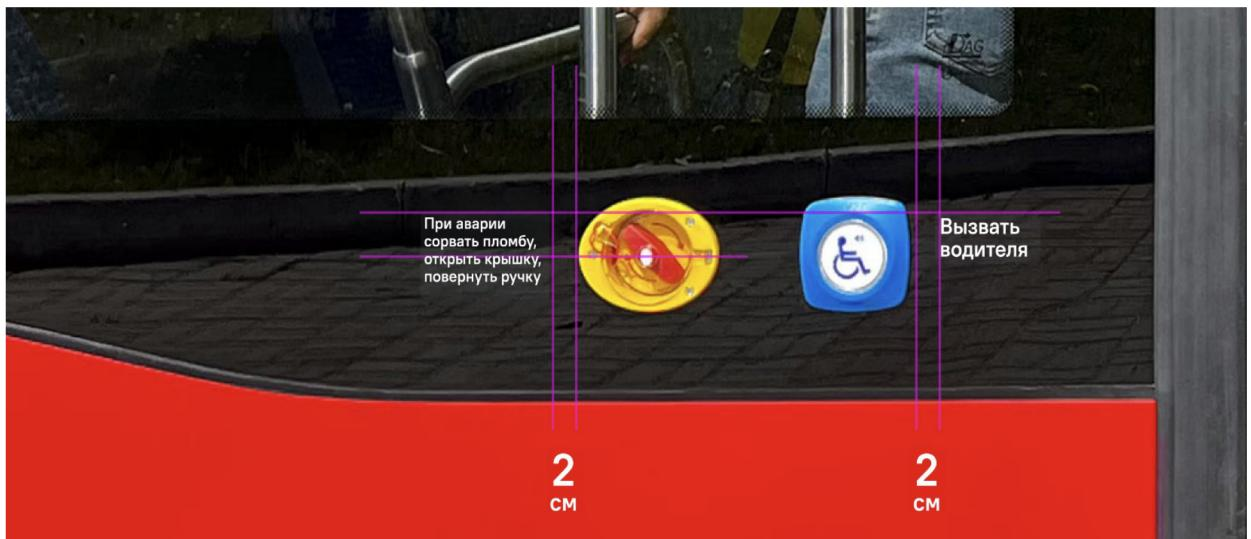
Наклейка [63-W Открыть двери снаружи] клеится вертикально у каждой двери по центру ручки аварийного открывания дверей. Отступ от ручки - 2 см влево. Наклейка [32 Вызвать водителя] выравнивается верхом по верху наклейки [63-W Открыть двери снаружи] и клеится в 2 см правее кнопки вызова водителя.
