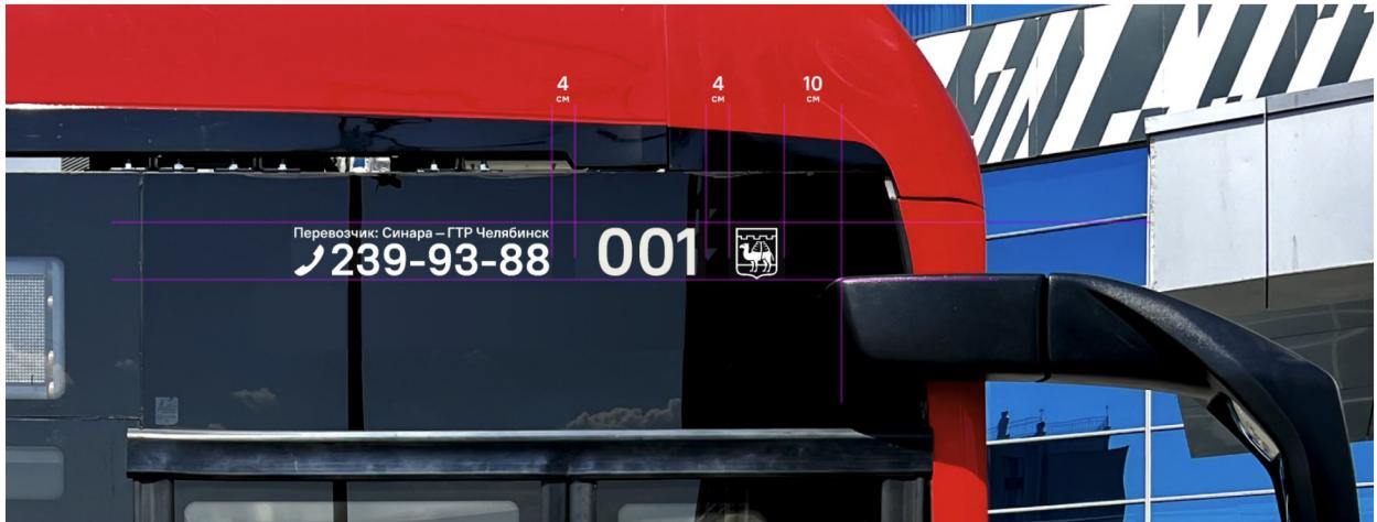
[20 Перевозчик], [03 Бортовой номер] и [21 Герб Челябинска]. Наклейки имеют высоту 10 см, расстояние между наклейками - 4 см. Наклейки выравниваются низом по верху зеркала с расстоянием от края зеркала в 10 см.
