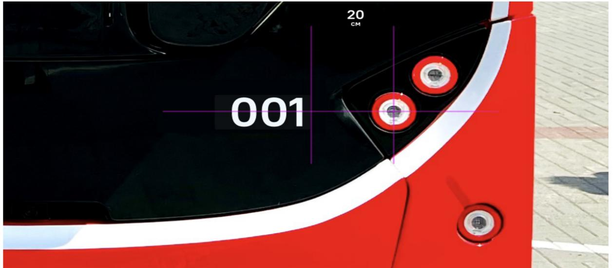
Наклейка [03 Бортовой номер] наносится в 20 см от левого края нижней из двух фар. Центрирование по вертикали - по центру той же фары.
