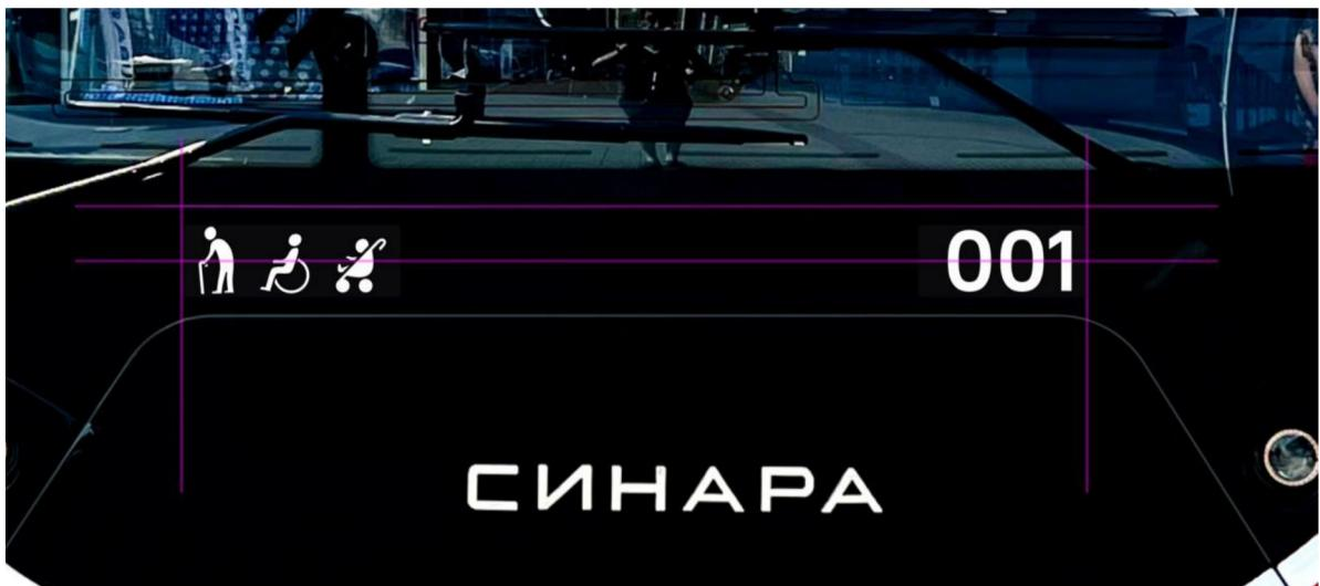
Наклейки [22 Три персонажа влево] и [03 Бортовой номер] выравниваются по высоте друг с другом и клеятся вертикально по центру полосы между стеклом и нижней закруглённой панелью с логотипом «Синара». Левая наклейка [22 Три персонажа влево] выравнивается левым краем по началу левого скругления панели
