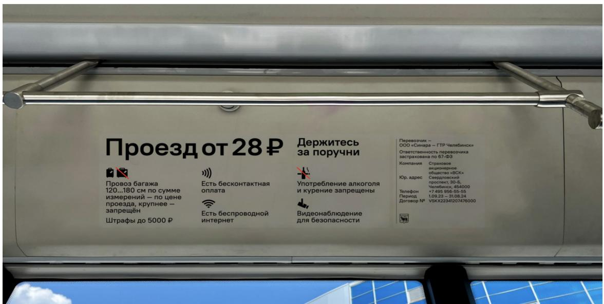
Наклейки [01 Информация о тарифах] и [02 Перевозчик] наносятся рядом, на расстоянии около 1 см, без наложения. Они выполнены отдельными наклейками для возможности их независимой замены.
