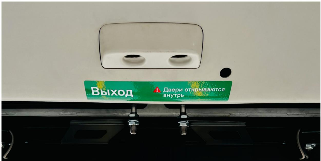
Зелёная наклейка [16 Выход] выравнивается по центру дверей, клеится посередине между изгибом и отверстием справа.
