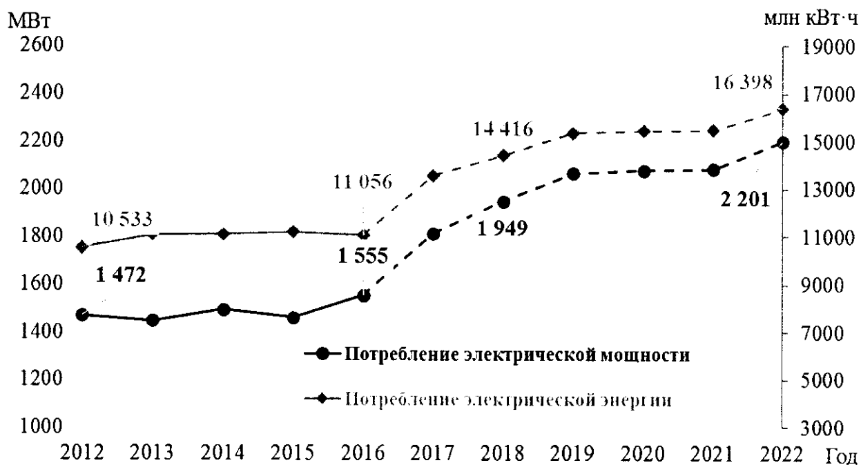
Схема 26. Динамика изменения максимума нагрузки и потребления электроэнергии ЭЭС ЯНАО на 2012 – 2016 годы (факт) и 2017 – 2022 годы (умеренно-оптимистический прогноз)
